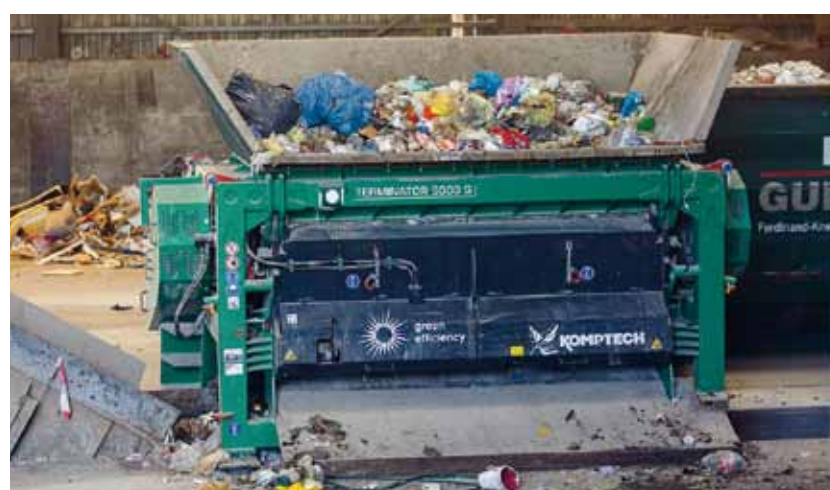
Mehrere hundert Tonnen Abfall wurden mit dem Zerkleinerer von Komptech unter definierten Einstellungen kleingemacht, danach gesiebt und sortiert. Foto: Komptech
