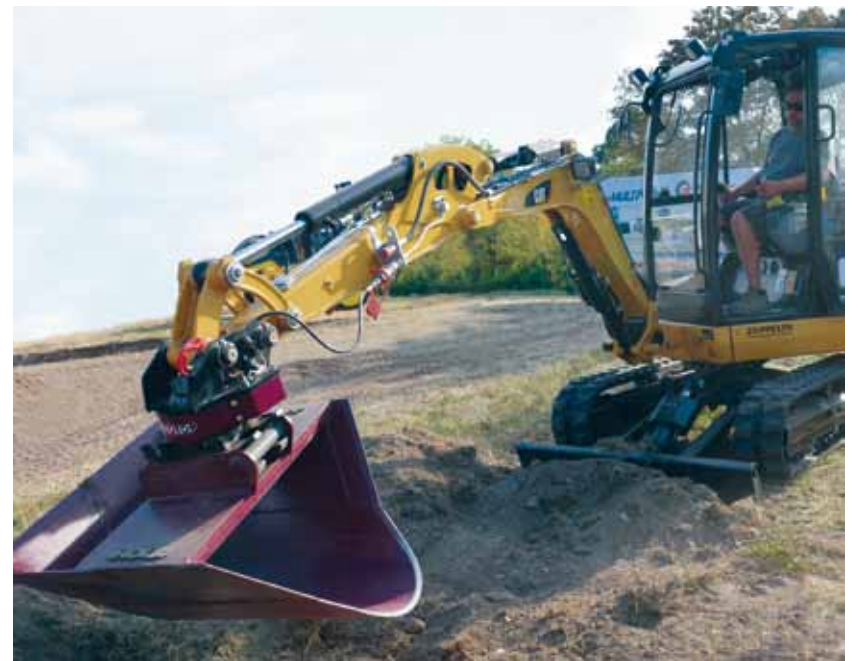
Mit dem Drehantrieb Rototop können alle Anbaugeräte betrieben werden. Foto: Holp
