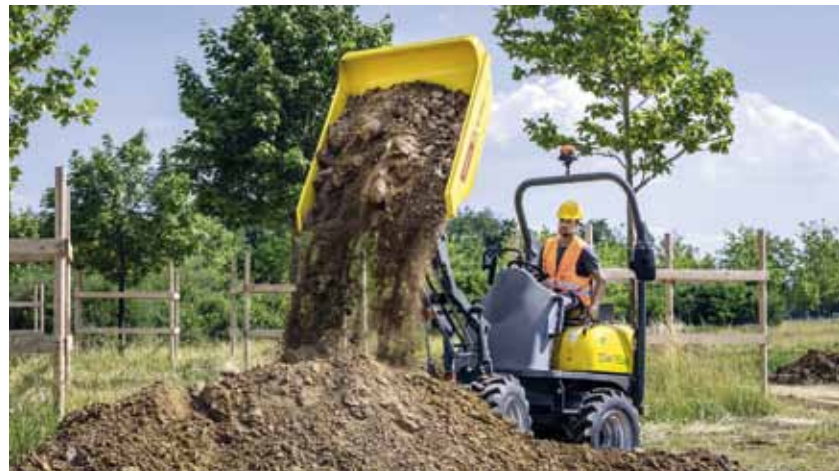
Raddumper mit Elektroantrieb: Der DW15e wird derzeit von Zeppelin Rental für seine Kunden getestet und demnächst zugeführt. Foto: Wacker Neuson
