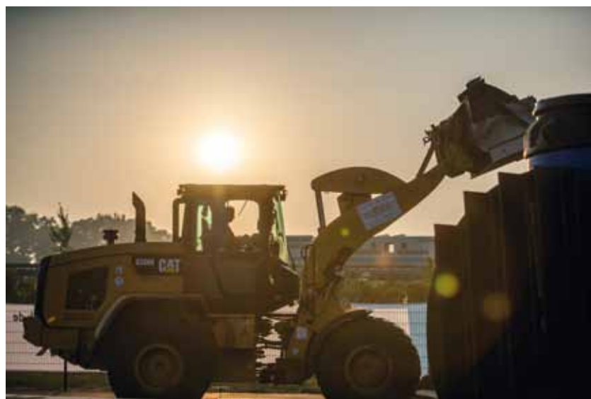
Der Cat Radlader 930M legte die Mieten als Zwischenlager an. Fotos: Wübker
