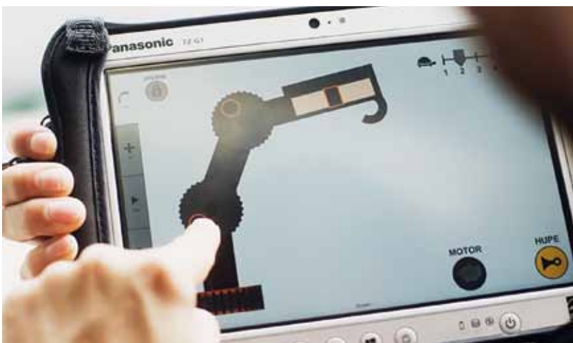
Neue Steuerungskonzepte für Krane per Tablet entwickelten die Forscher der TU München. Foto: Daniel Delang/TUM
