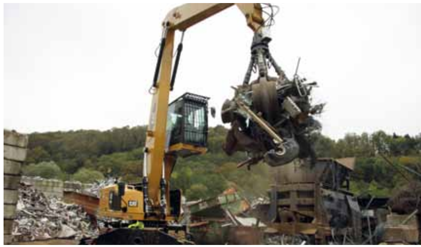
Dank der hochfahrbaren Kabine des Umschlagbaggers hat der Maschinist die nötige Höhe, um die Schrottschere zu bedienen, wenn Metalle und Schrott auf 40 Zentimeter Länge zu schneiden sind.
