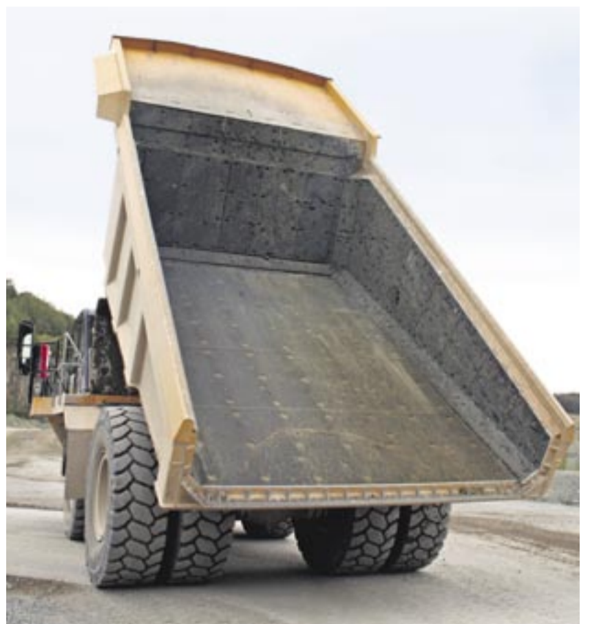
Boden und Seitenwände der Mulde sind beim Cat 775F mit Gummipplatten ausgekleidet.
