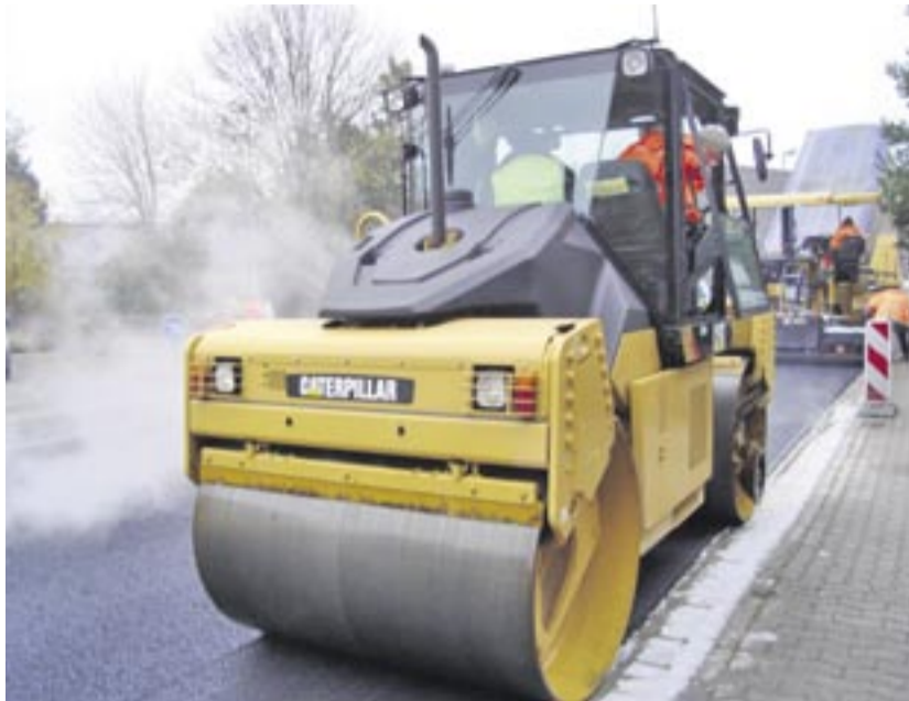
Ausgestattet mit einer neuartigen Aktivlenkung: die CD54 von Cat. Foto: Zeppelin
