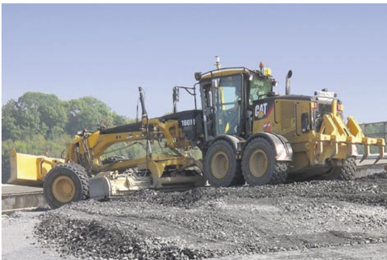
Mit ihrem Cat Motorgrader muss die Firma Koch ein großes Pensum an Erdbewegung bewältigen.
