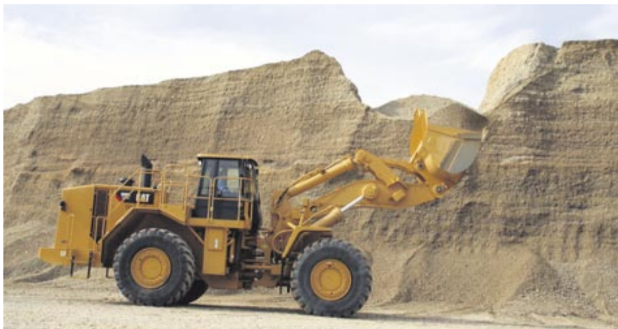
Mit ihren hohen Reißkräften soll die Baumaschine Rohkies und Sand von der 15 Meter hohen Wand lösen.
