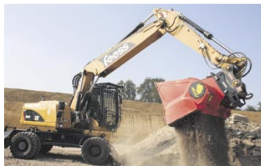
Um die verschiedenen Fraktionen von Bauschutt aufzubereiten, wird auf dem neuen Recyclingpark ein Cat Mobilbagger M318D mit einer ALLU-Separator-Schaukel eingesetzt. Fotos: Zeppelin
