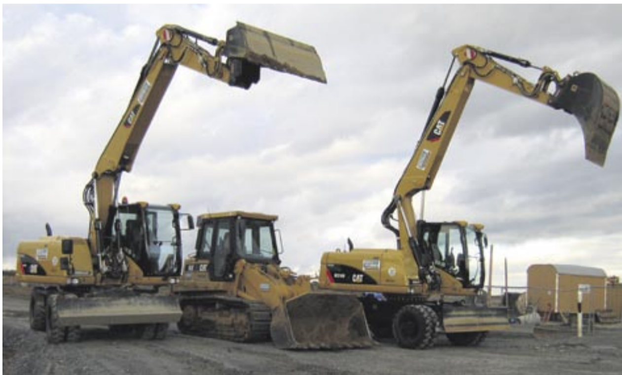
Für seine beiden größten Geschäftsfelder, den Straßen- und Tiefbau, setzen Dietz und Strobel die Cat Mobilbagger M313D sowie M316D und die Cat Laderaupen 953C ein. Fotos: Zeppelin
