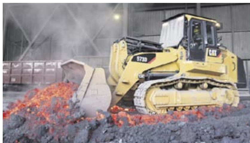
Gewappnet gegen hohe Temperaturen: Die Hitze darf dem Gerät samt Schaufel nichts anhaben, wenn es mit der heißen Elektroofenschlacke in Kontakt kommt.
