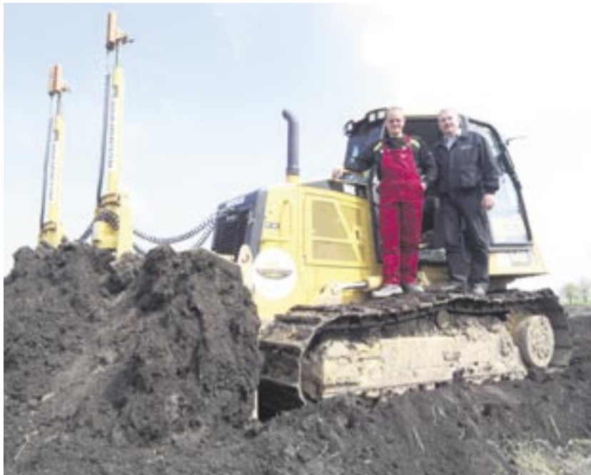
Dozerfahrer Sebastian Raube (links) und Matthias Hochheim von der Zeppelin Niederlassung Erfurt auf dem Cat Dozer D6K mit der dualen Lasersteuerung. Foto: Zeppelin
