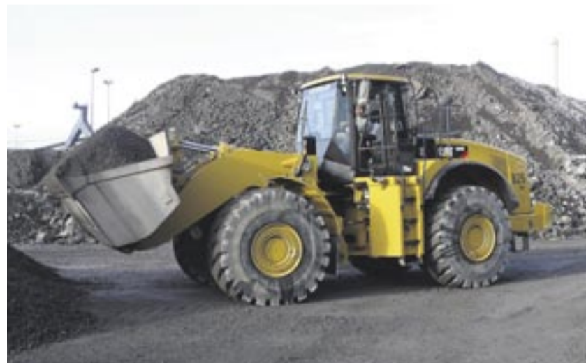
25 Radlader mit mobiler Wägetechnik sind im HKM-Stahlwerk Huckingen für den Transport von Schlacke verantwortlich.
