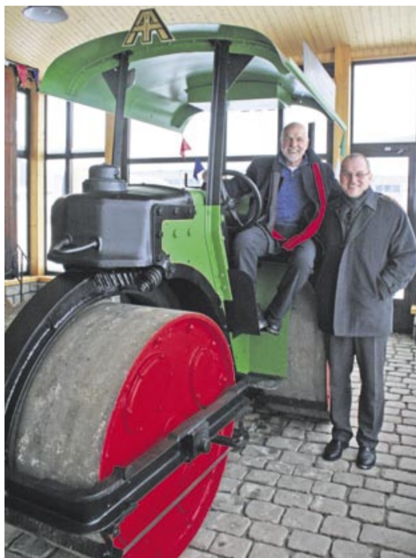
Geschäftsführer Andreas Adam (links) zeigt Olaf Kosbi, Zeppelin Verkäufer der Niederlassung Dresden, seine Schmuckstücke, wie diese Dieselwalze der Firma Zettelmeyer. Das Besondere daran ist der Sitz neben dem Fahrerhaus. Dadurch kann der Fahrer genau die Bordsteinkante sehen, an der er entlang walzen muss.
