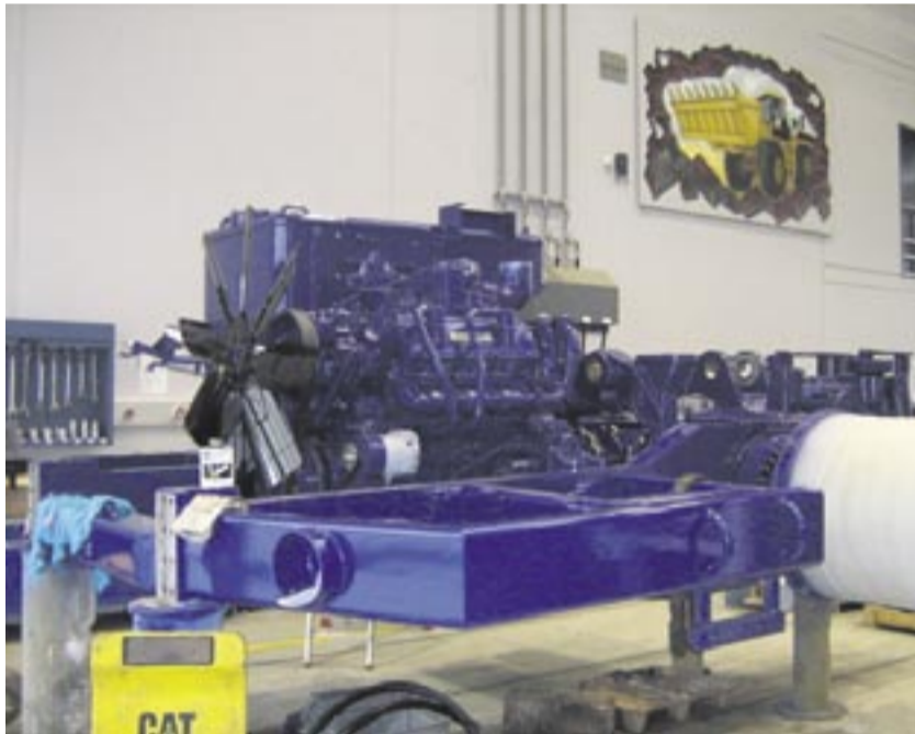
Sämtliche Bauteile haben die Servicemitarbeiter demontiert, inspiziert und instand gesetzt. Fotos (3): Zeppelin
