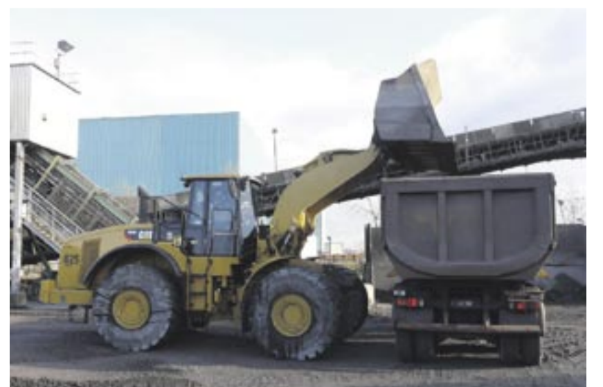
Zu den Aufgaben der Radlader gehört das Beladen von Lkw mit verkaufsfertiger Schlacke, die unter anderem im Straßen- und Wegebau zum Einsatz kommt.
