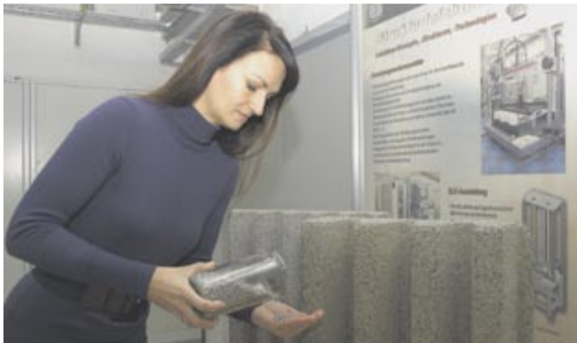
Im Labor entwickelte Dr. Sandra Gelbrich die mineralische Beschichtung für das Granulat aus recyceltem Gummi, das in die Lärmschutzwände eingebracht wird. Foto: Christine Kornack
