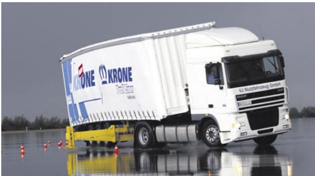
Bei einem Fahrversuch wird die Festigkeit des Aufbaus festgestellt.
