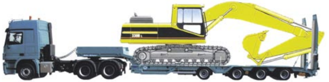
Durch die hohe Nutzlast des TS 4 RM von Müller-Mittelal sowie die 9,7 Meter lange Ladefläche ist selbst der sichere Transport eines 30 Tonnen schweren Cat Kettenbaggers realisierbar. Foto: Müller-Mittelal
