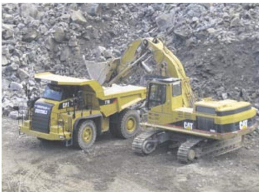
Bevor der Gneis in der Mulde landet, wird er gesprengt und dann mit dem Cat Kettenbagger 365 B auf den Skw verladen.
