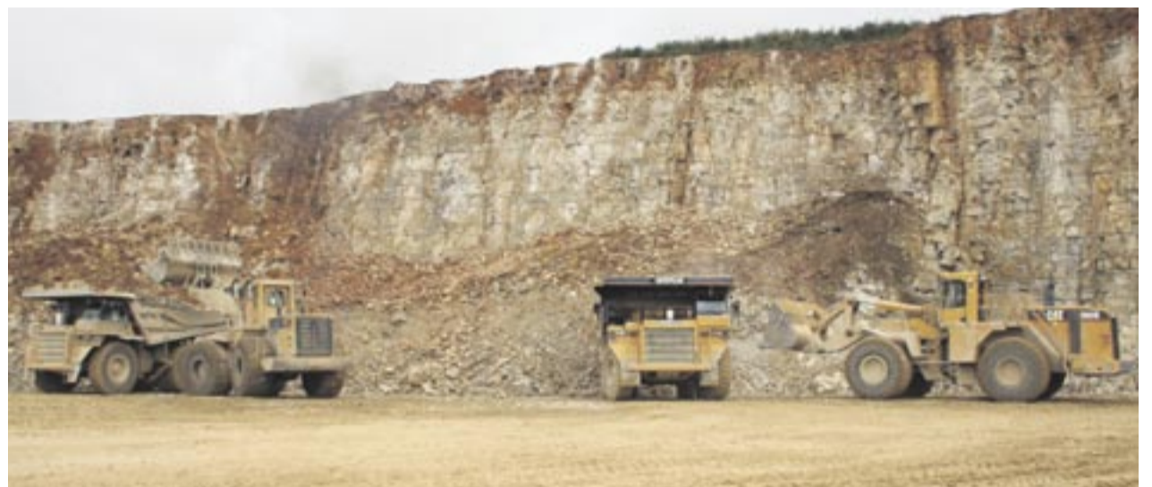
Unterstützt wird der Cat-Radlader 992 G von einem 992 C. Beide sorgen dafür, dass die Cat-Mulden 777D in vier Ladespielen mit dem Material beladen werden.
