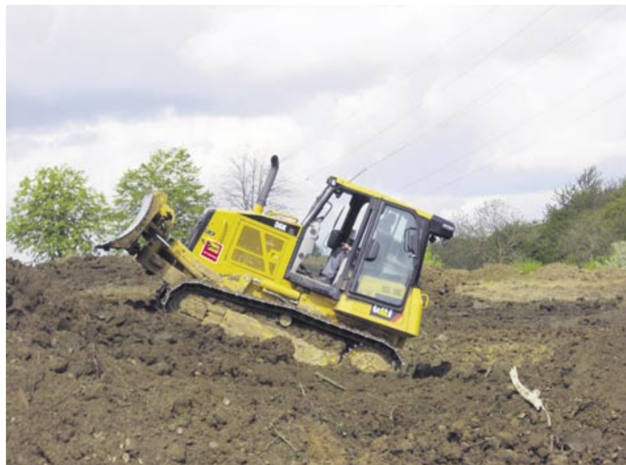
Auch bei weichem Untergrund wie hier im Falle des Sportplatzbaus in Bad Schönborn bietet sich der Cat-Dozer D6 aus der Mietflotte von MVS Zeppelin an. Foto: MVS Zeppelin
