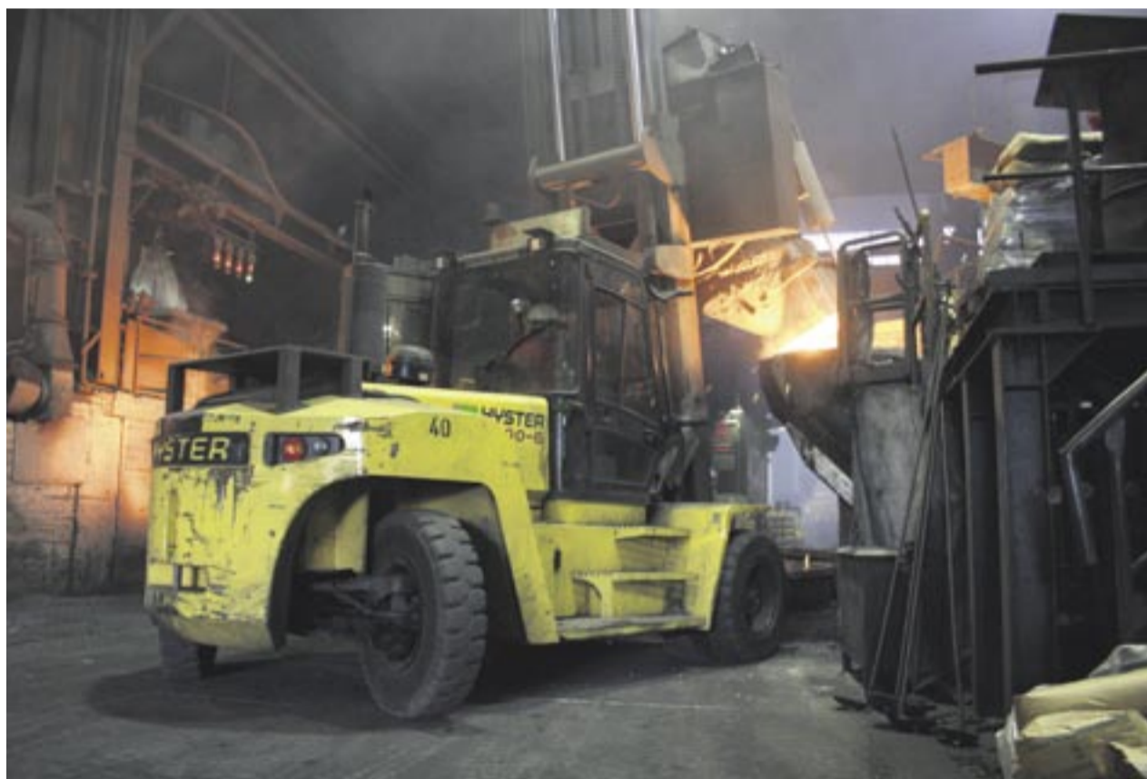
Der Sphäroguss wird nach der Magnesium-Behandlung über einen Vergießbofen mit Impfung in sandgefüllte Formenkästen gegossen. Fotos: Zeppelin
