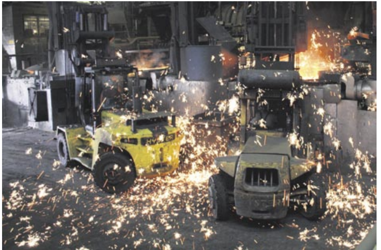
In der Eisengießerei der Firma Walter Hundhausen in Schwerte werden Hyster-Big Trucks unmittelbar in der Fertigung eingesetzt. Dabei haben sie unter anderem mit Spritzeisenkugeln zu kämpfen. Rechts im Bild ein Zwölf-Tonner aus dem Jahr 1977, der noch immer als Standby-Gerät eingesetzt wird, links ein neuer H16.00 XM mit Baujahr 2007.
