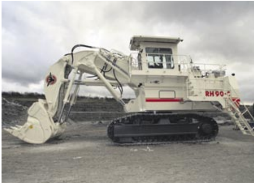
Vor Lärm und Erschütterungen sind die Anwohner eines nahe gelegenen Wohngebiets gefeit, denn die verursacht der neue Terex O&K Minenbagger beim Abbau von Kalkmergel nicht.
