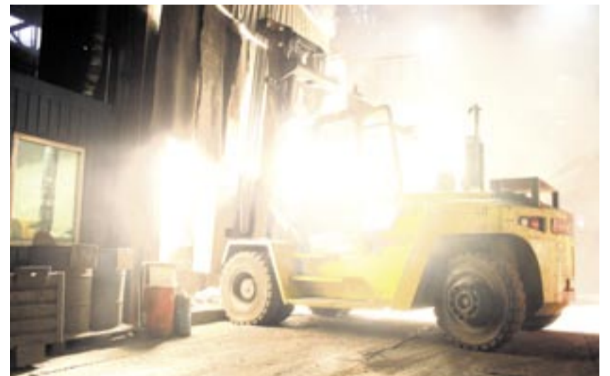
Um den hochwertigen Sphäroguss zu gewinnen, wird das Eisen mit Magnesium behandelt. Diese Reaktion ist nicht nur von viel Licht und Rauch begleitet, sondern lässt auch enorme Druckkräfte auf den Stapler einwirken.
