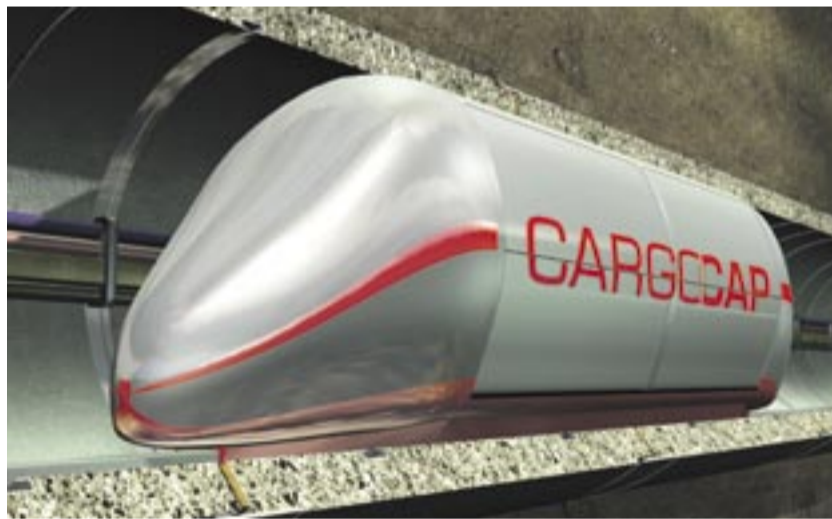
Transportkapsel im Fahrrohr: CargoCaps sollen die Straßen entlasten.
