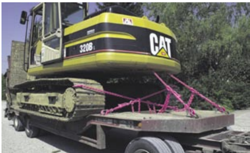
Cat-Bagger auf Auflieger.
