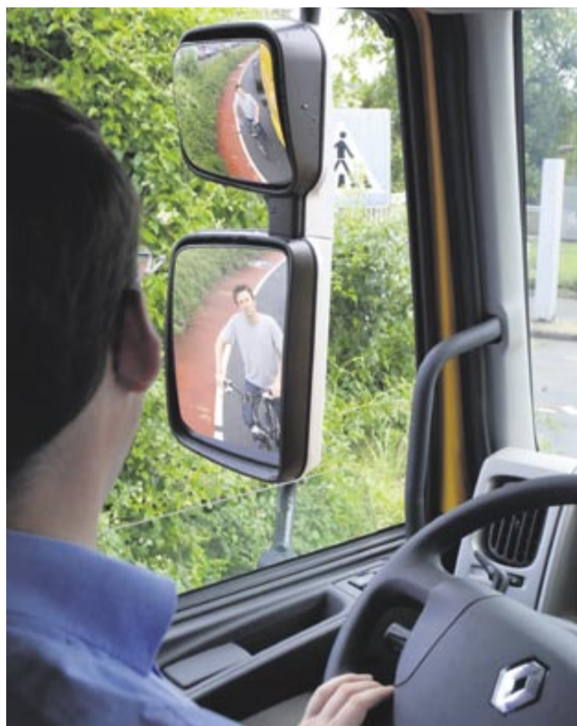
Bessere Sicht auf andere Verkehrsteilnehmer mit einem Weitwinkelspiegel.
