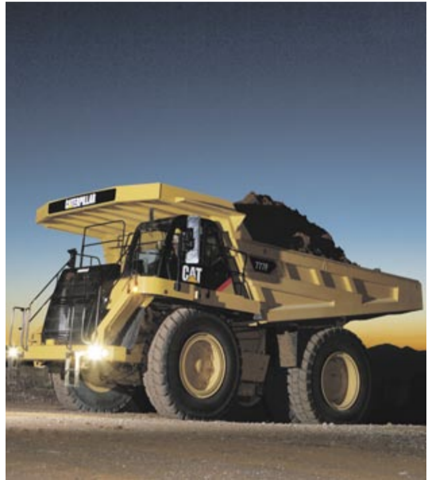
Über 50 verschiedene Maschinen stellen Caterpillar und Zeppelin auf der diesjährigen Bauma aus. Als schwergewichtiges, hochmodernes Transportmittel wird unter anderem ein 950 PS starker Muldenkipper vom Typ 777F mit umweltfreundlicher Acert-Technologie zu bestaunen sein. Foto: Zeppelin
