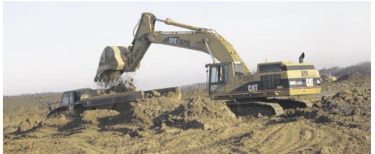
Ein Cat-Bagger 365B belud in nur einer Stunde 25 Cat-Dumper.
