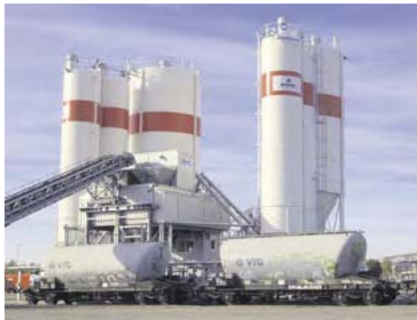
Auf einer etwa 70 000 Quadratmeter großen Fläche wurde ein Betonwerk direkt vor Ort errichtet. Foto: Günter Wicker/Photur/Berliner Flughäfen
