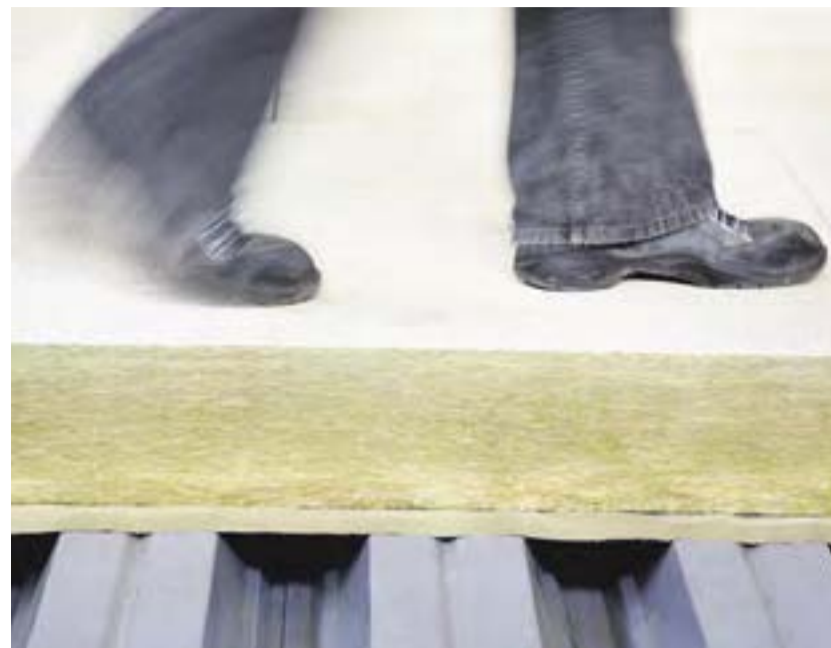
Durch den Verbund aus Steinwolle-Dämmplatte mit einer anorganischen, faserverstärkten Beschichtung verfügt „Megarock“ über eine Punktlast von mindestens 1 800 Newton. Fotos: Rockwool
