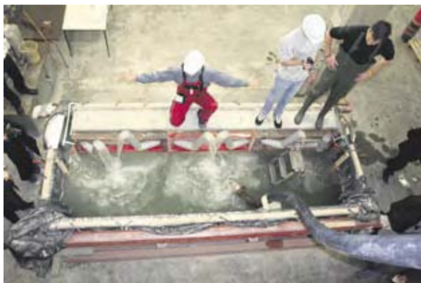
Versuchsaufbau: Betonieren unter Wasser.
