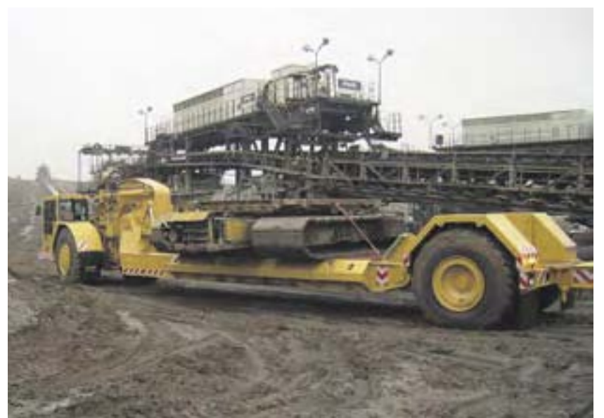
Um die Maschinen innerhalb des Tagebaus zu transportieren, setzt RWE Power wegen den Steigungen im Gelände einen Cat-Scraper ein. Fotos: Zeppelin
