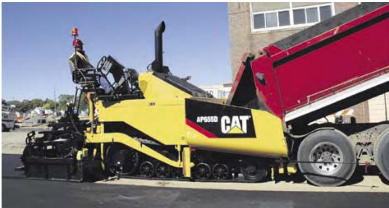
Mit dem Asphaltfertiger AP-655D fügt Caterpillar seiner Produktpalette im Straßenbau ein Modell hinzu, das mit hoher Einbauleistung, Kraftstoffeffizienz und einem hochwertigem Deckenbild überzeugt.
