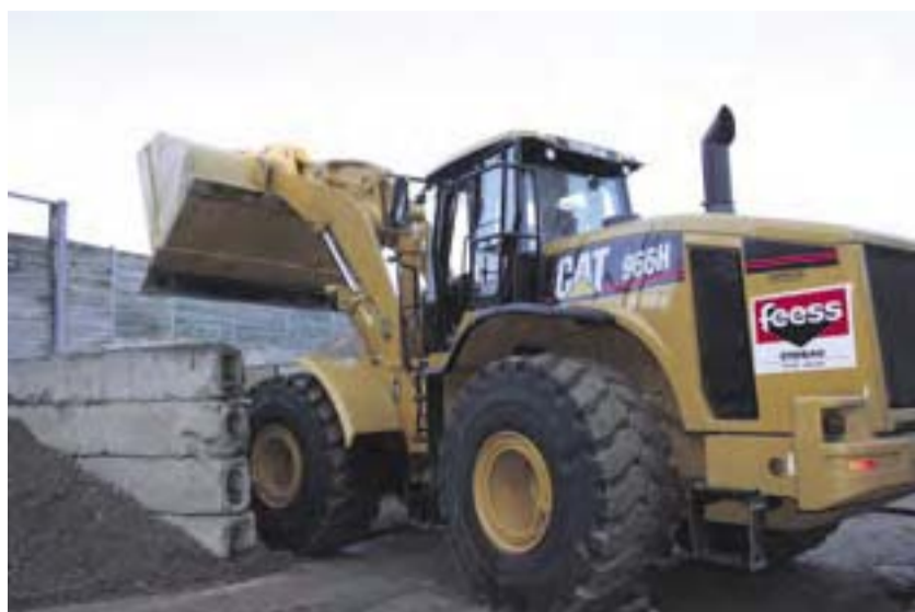
Jüngstes Mitglied im Fuhrpark: ein Cat-Radlader 966 H, der Recyclingmaterial und Bauschutt umschlägt.
