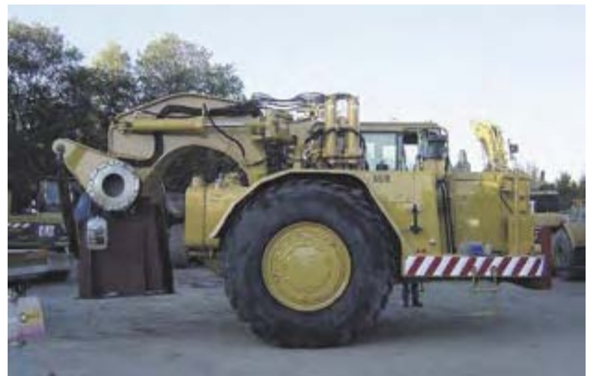
Wurde beim Rebuild komplett überholt: der Zugkopf samt Verbindung von Zugkopf und Tiefladerbett des Cat-Scrapers 651 E.
