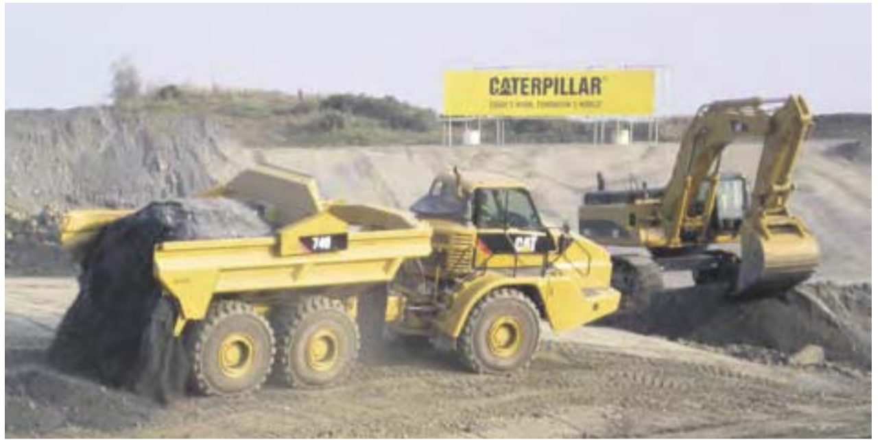
Neues gibt es auch von den knickgelenkten Dumpfern: Mit dem 730 Ejector bietet Caterpillar in der 30-Tonnen-Klasse das Abladen per Ausschub an.
