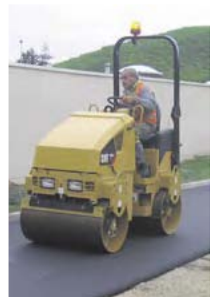
Kompakt und wendig: Die neuen Tandemvibrationswalzen CB14 gibt es in vier verschiedenen Modellen, die sich unter anderem durch den größten Wassertank ihrer Klasse und durch innovativ konstruierte Bandagen auszeichnen.
