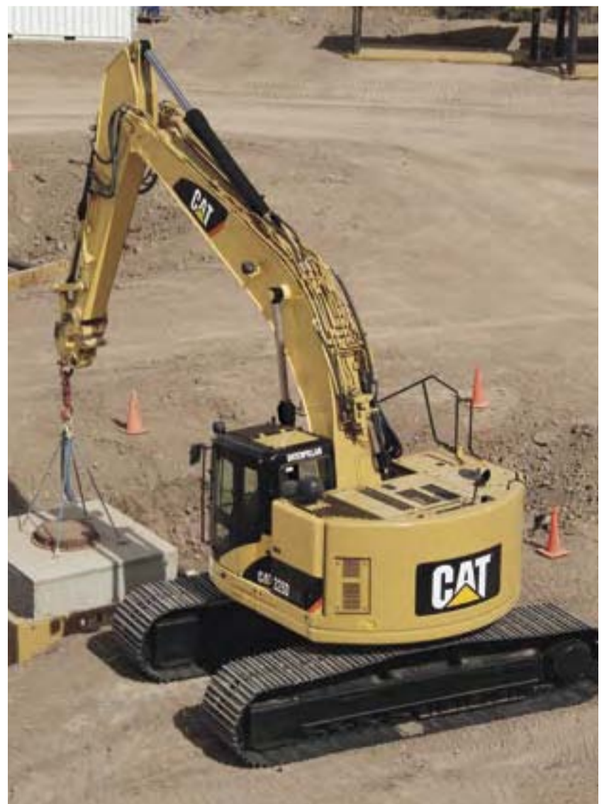
Minimal im Platzverbrauch und deshalb umso vielseitiger einsetzbar ist der neue, 152 kW (206 PS) starke Kurzheckbagger Cat 328D. Foto: Zeppelin
