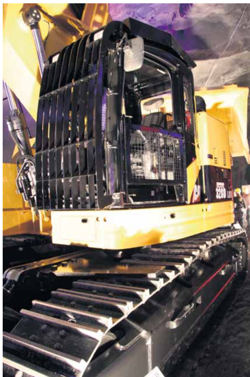
Besonderes Interesse weckte der von der Zeppelin Niederlassung Böblingen präsentierte Cat Tunnelbagger Cat 328 DLCR aufgrund seines Schutzgitters. Fotos: Zeppelin
