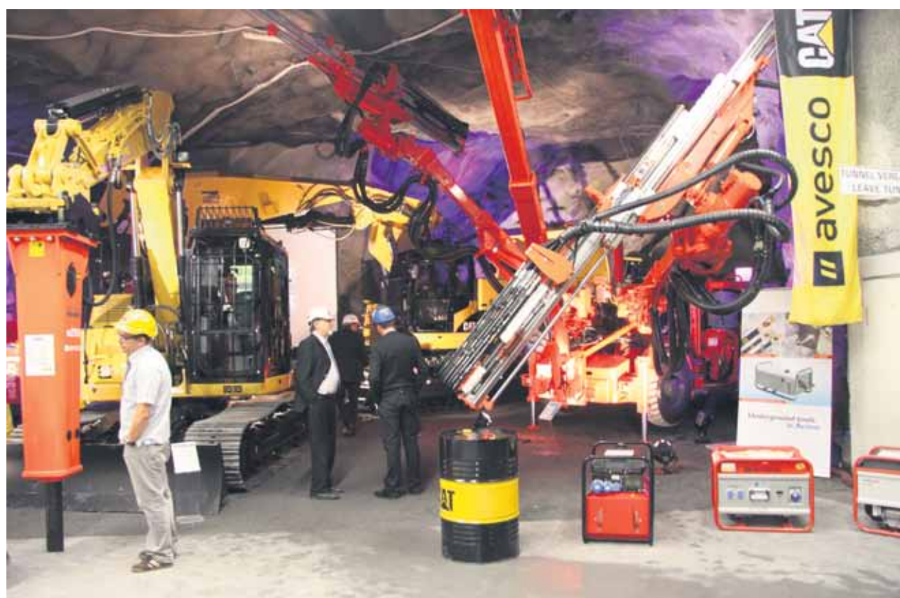
Der Schweizer Caterpillar Händler Avesco zeigte einen Cat Bagger vom Typ 314, zugeschnitten auf Tunnelleinsätze.
