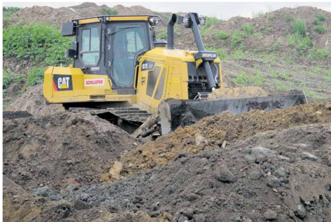
Der neue Dozer vom Typ Cat D7E legt bei der Schlieper Baustoff + Transport GmbH eine starke Schubleistung an den Tag.
