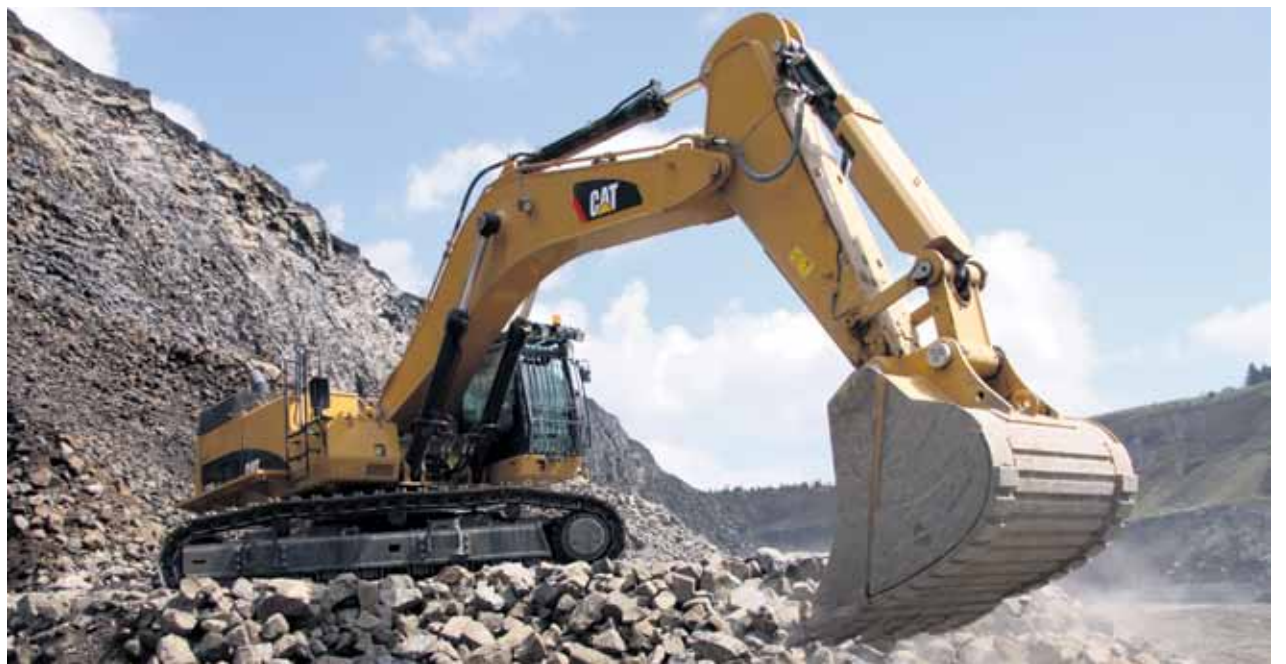
Der Cat 374D ist gegenüber dem früheren Hochlöffelbagger zwar eine Baggergröße kleiner, doch er benötigt für die gleiche Förderleistung acht Löffelfüllungen, um den Muldenkipper mit Basalt zu beladen. Insgesamt spart sich der Betrieb ein Ladespiel - zuvor waren neun Ladespiele erforderlich.
