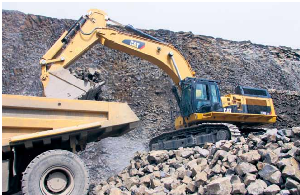
Steht der Bagger auf dem Haufwerk, so hat der Fahrer eine gute Sicht in die Mulde und erkennt, wie viel Material noch hineinpasst.
