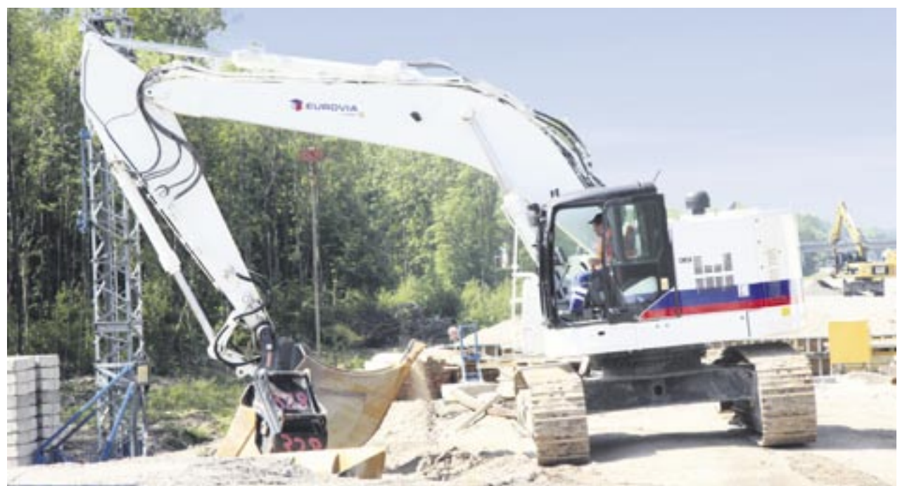
Ähnlich wie im Kanalbau hat es der neue Cat 328DLCR an der A5 mit schwerer Arbeit zu tun.
