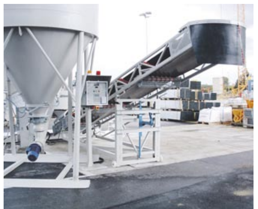
Das Austragsband ist höhenverstellbar. So kann der Beton auf einer Lkw-Pritsche als auch auf einem Pkw-Anhänger direkt verladen werden.
