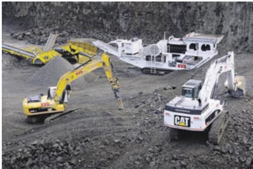
Beschickt wird der Aufgabebunker des neuen mobilen Backenbrechers mit einem Cat Kettenbagger 345D. Foto: Phoenix-Zeppelin
