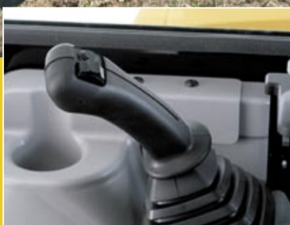
Hydraulische Vorsteuerung garantiert feinfühligere Arbeitsbewegungen
