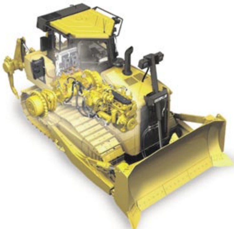
Das moderne Antriebskonzept der Cat D7E ist erst durch die wesentlich kleinere und leistungsstärkere Halbleitertechnik möglich geworden.
