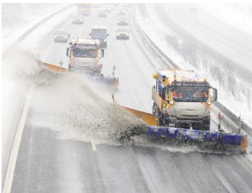
Streufahrzeuge in der Staffel sorgen für eine sichere Fahrbahn.
