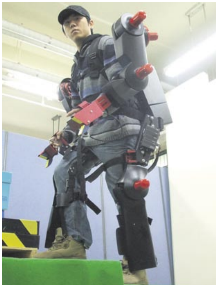
Ein Student testet den Exoskeleton-Roboter von Dr. Seung Yeol Lee für die Anwendung auf Baustellen in Seoul. Foto: Seung Yeol Lee/Hanyang University/TU München
