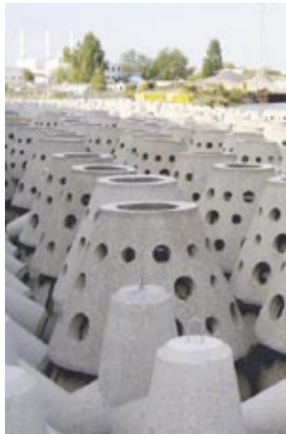
Bieten Fischen und anderen Lebewesen einen Lebensraum: Elemente aus Beton.
