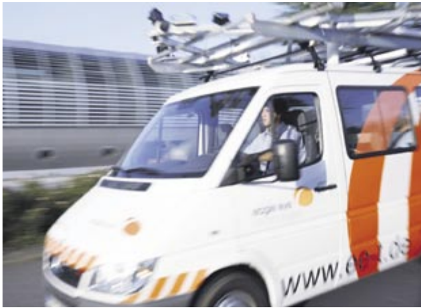
Bei der Technologie von eagle eye werden Flächen- und Zustandsdaten aus der Befahrung heraus ermittelt. Foto: eagle eye
