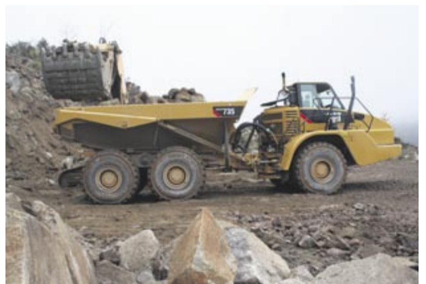
Der neue Cat Dumper 735 wird gerade mit Granit beladen. Fotos: Zeppelin
