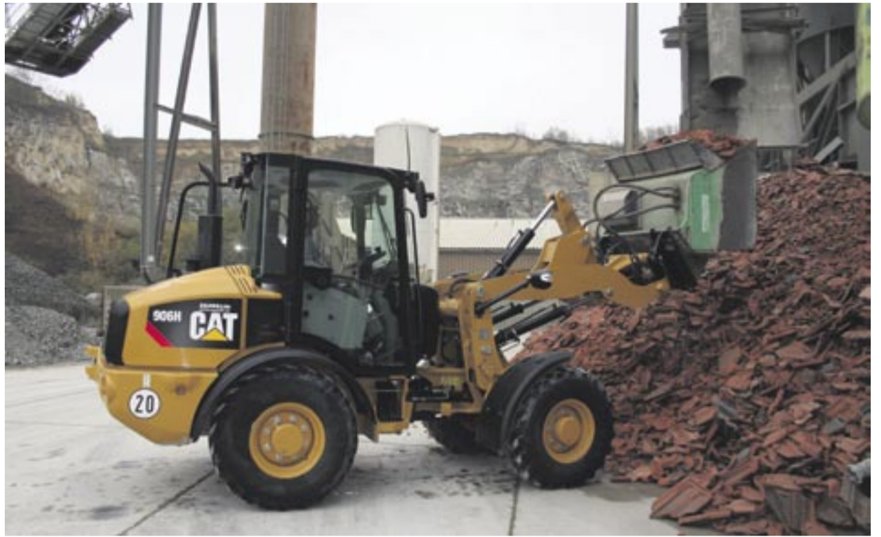
Die Zeppelin Niederlassung Freiburg hat die Maschinenausrüstung auf die Belange von Hauri ausgerichtet, insbesondere hat sie die Hydraulik für den Betrieb des Häckslers umgerüstet, mit dem Ziegelbruch zerkleinert wird. Foto: Zeppelin
