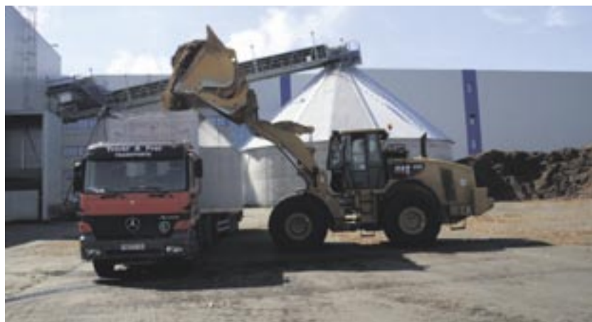
Extra mit einer Hochkippschaufel ausgerüstet, um besser die Lkw mit Rinde beladen zu können, wurde ein Cat-Radlader 972 H. Fotos: Zeppelin
