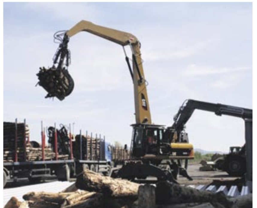
Entlädt im Wechsel mit einem Umschlagstapler Holzstämmen von Lkw und einem Güterzug: ein Cat-Umschlagbagger M322D MH.
