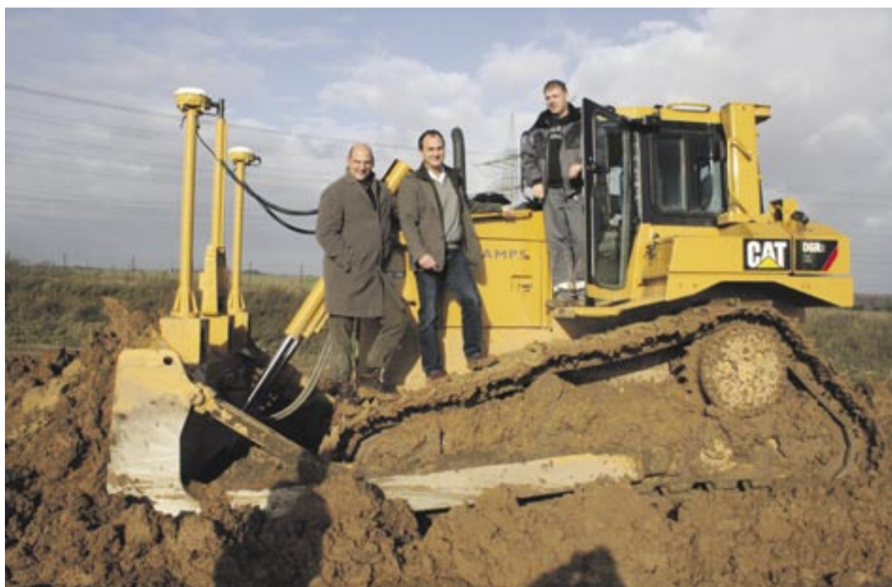
Bei der Rekultivierung und Rückverfüllung der ehemaligen Kiesgrube Dormagen-Gohr setzt Andreas Kamps den neuen Cat-Kettendozer D6 RX LSU von der Zeppelin-Niederlassung Neuss ein. Die Maschine ist mit dem neuen „System One“-Laufwerk und mit dem GPS-Maschinensteuerungssystem AccuGrade ausgerüstet. Beim Kundenbesuch (von links): Andreas Tiedmann, Zeppelin-Niederlassungsleiter Oberhausen und Neuss, Andreas Kamps und Fahrer Stefan Küppers. Fotos: Zeppelin
