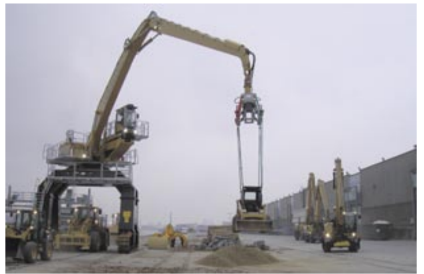
Der MultiDocker, ein vielseitig einzusetzendes Umschlaggerät, hebt den Cat SSL216B am Multifunktionshaken hängend aus dem Massengutfrachter.
