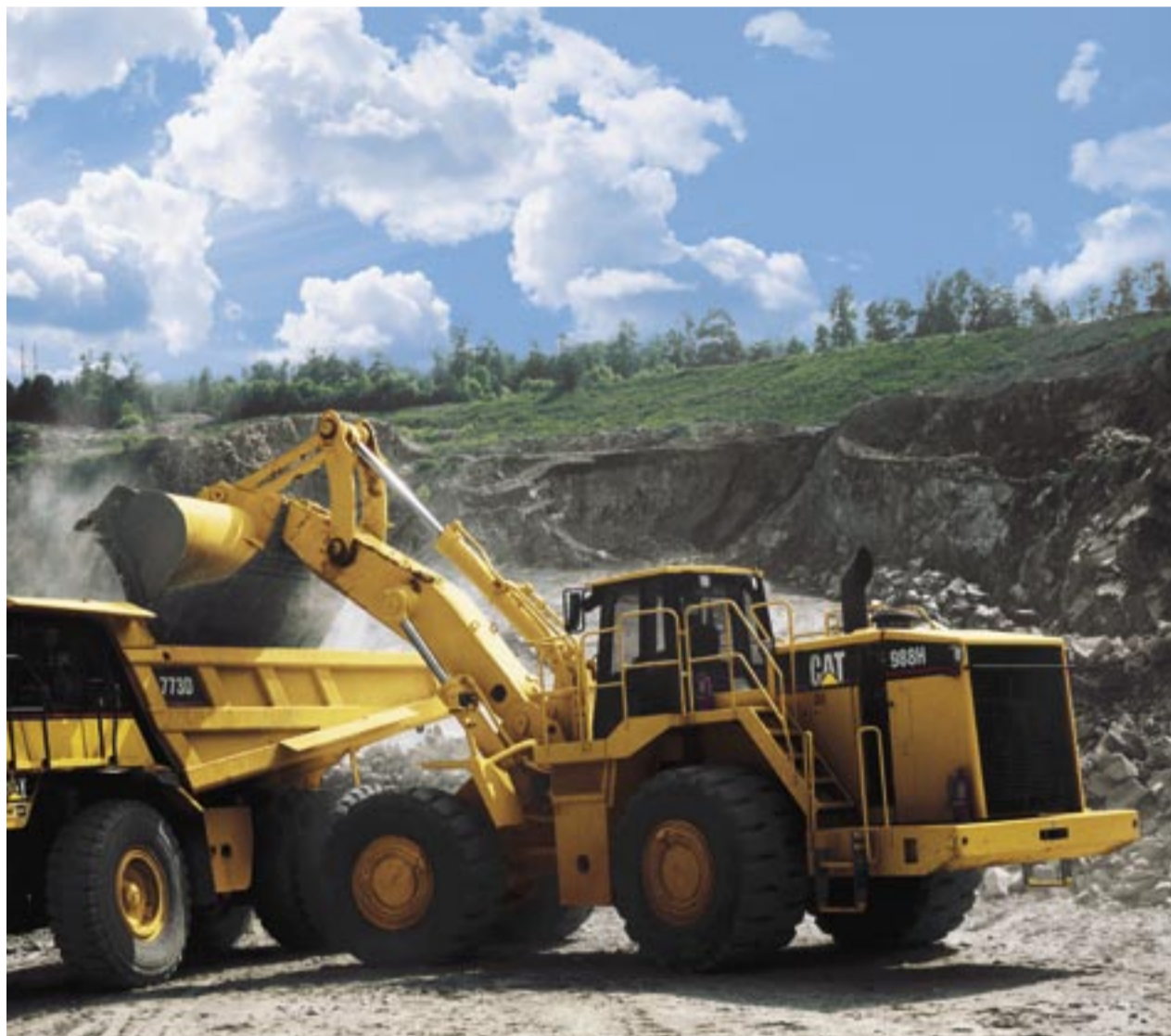
Ausgerüstet mit dem neuen Kraftstoff-Management-System von Caterpillar werden bei den Radladern vom Typ 988H durchschnittliche Kraftstoffeinsparungen von 15 Prozent erzielt. Foto: Zeppelin
