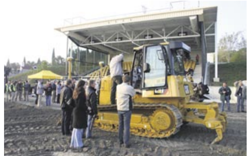
Dass Cat bei den Dozern der D6K-Serie einen hydrostatischen Antrieb anbietet, stieß auf reges Interesse bei den Journalisten.
