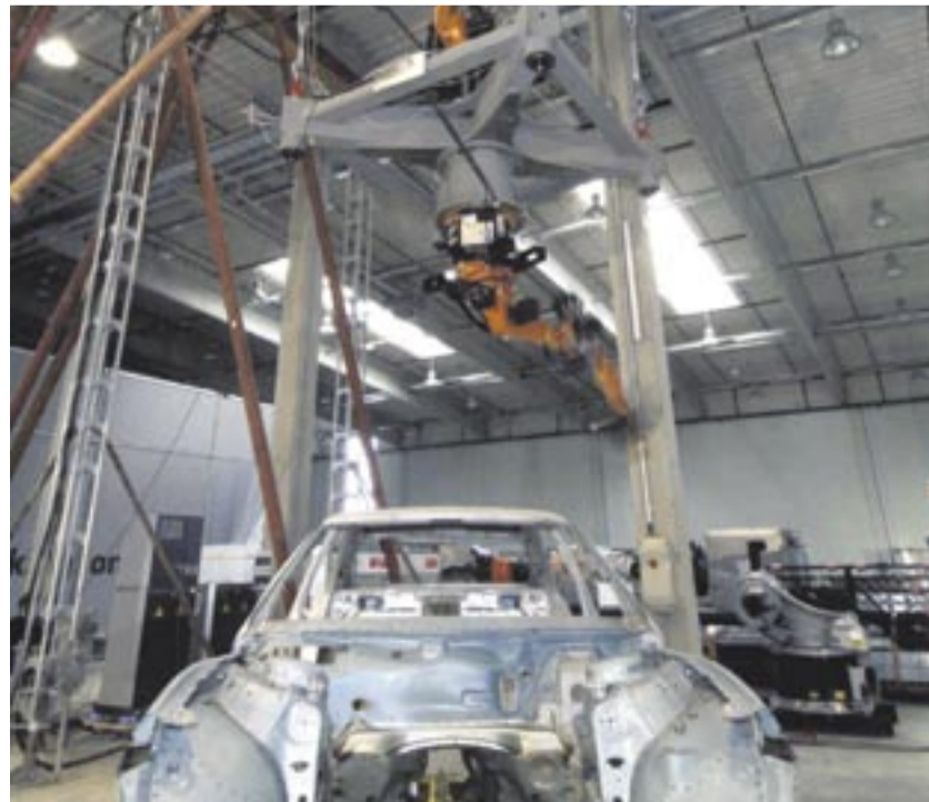
Außergewöhnlicher Einsatz für sechs Lastrahmenstützen, vier Stahlträger und 16 BKS-Stützen: Als Aufhängung für zwei schwebende Roboter waren sie Teil eines wissenschaftlichen Experiments. Foto: Hünnebeck
