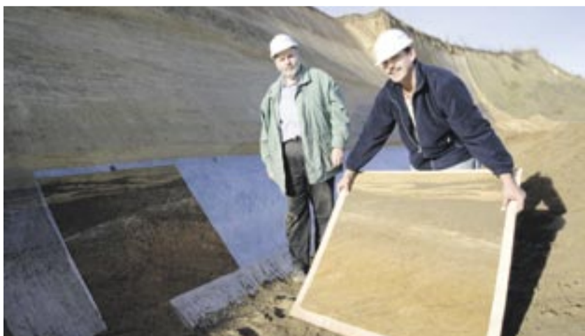
Die Technik des Lackabzugs wurde um 1930 entwickelt. In aufwändigen Arbeitsschritten werden dünne Schichten herauspräpariert. Dabei wird der Abdruck dauerhaft auf einer festen Unterlage fixiert.
