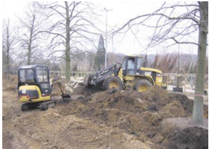
Caterpillar-Baumaschinen, wie der Radlader und Minibagger, können nicht nur Berge, sondern auch Bäume versetzen. Sie werden bei der Baumschule Bruns im Ammerland eingesetzt. Die Geräte holen die Pflanzen mit einem Ballenstecher aus der Erde. An die Baumaschinen sind Ballenzangen angebracht, damit sie die langen Baumstämme gut im Griff haben, wenn sie diese dann auf Lkw zum Transport verladen. Fotos: Baumschule Bruns
