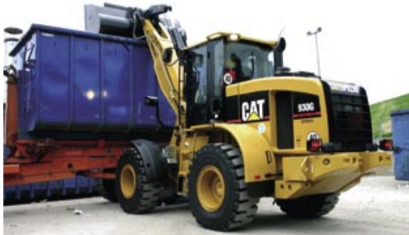
Aufgrund seiner großen Hubhöhe kann der Cat 930G auch problemlos höher stehende Container beladen. Fotos: Zeppelin
