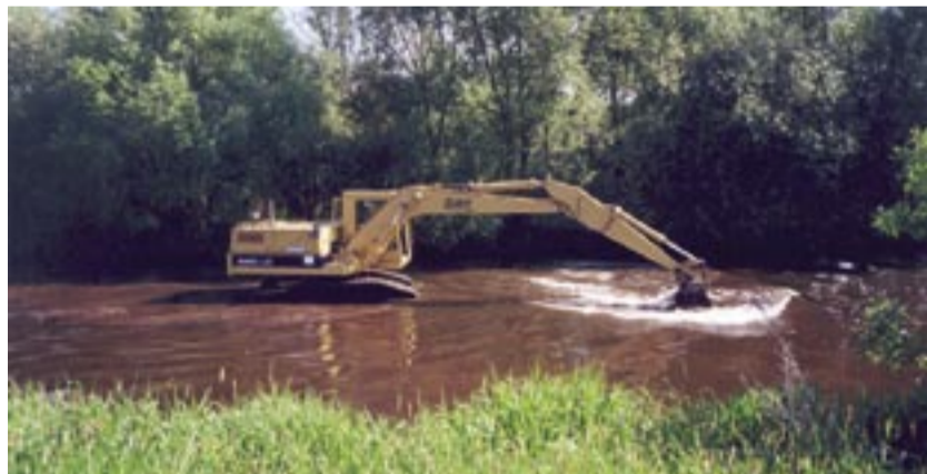
Der mittlerweile 17 Jahre und 21 000 Betriebsstunden alte Cat 215 LC bei der Räumung von Sandbänken in der Wüme im Sommer 2000. Foto: Zeppelin
