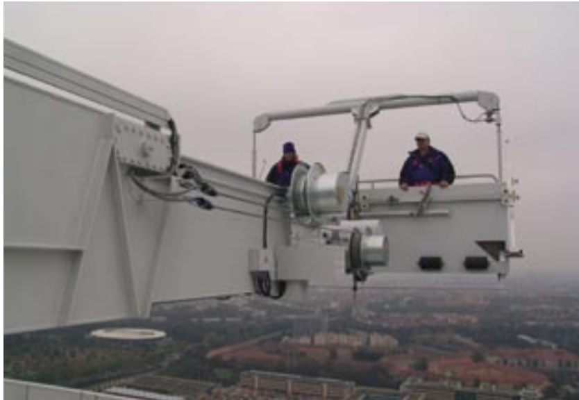
Für Scheibentransporte und spätere Wartungseinsätze konzipiert: GEDA-Fassadenaufzug L01 am Münchner „Uptown Tower“. Foto: GEDA
