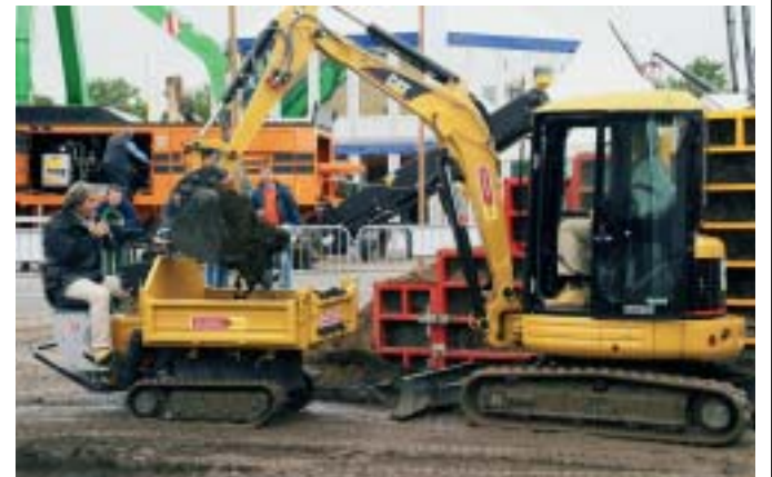
Ladespielchen: Mini-Dumper und Kurzheck-Bagger Cat 303 CR passen bestens zusammen. Fahrer und Maschinen waren auf dem Zeppelin-Demogelände sichtbar in ihrem Element.
