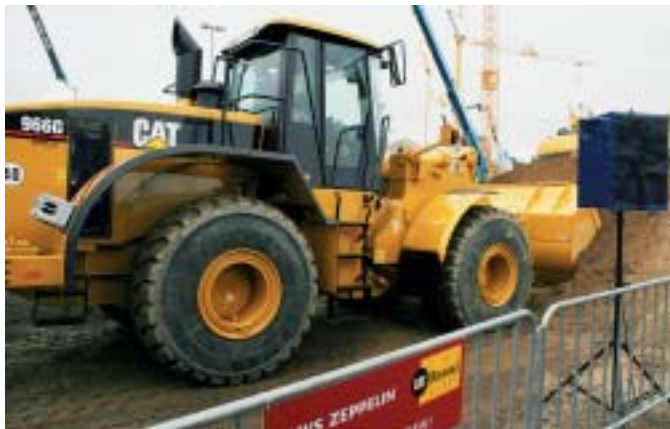
„Techno Star“ unter den Caterpillar-Radladern: Cat 966G Serie II. Sein optional erhältliches „Autodig“-System automatisiert den Schaufelfüllvorgang und entlastet somit den Fahrer.
