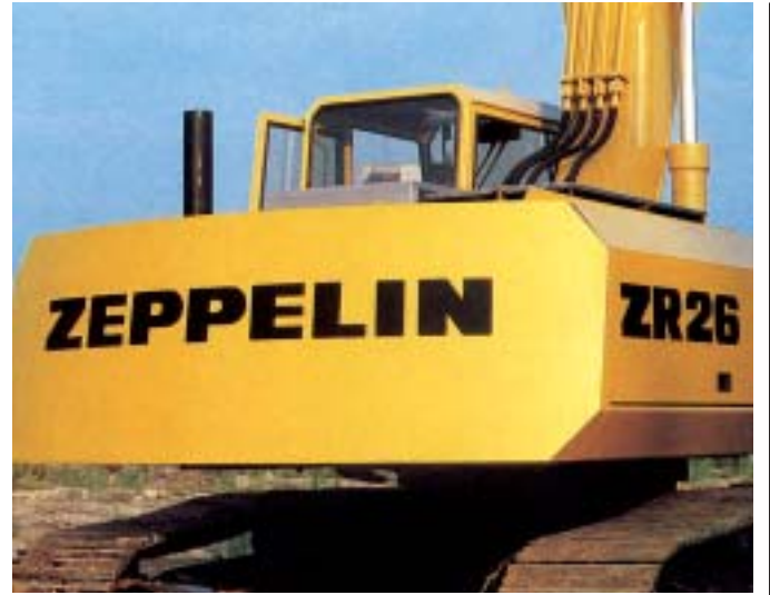
Die Zeppelin-Hydraulikbagger wiesen ein sehr modernes, klares Design auf, das sogar preiswürdig war. Hervorgehoben wurde 1985 der äußerst niedrige, richtungsweisende Innenschallpegel des Fahrerhauses von nur 74 dB(A).
