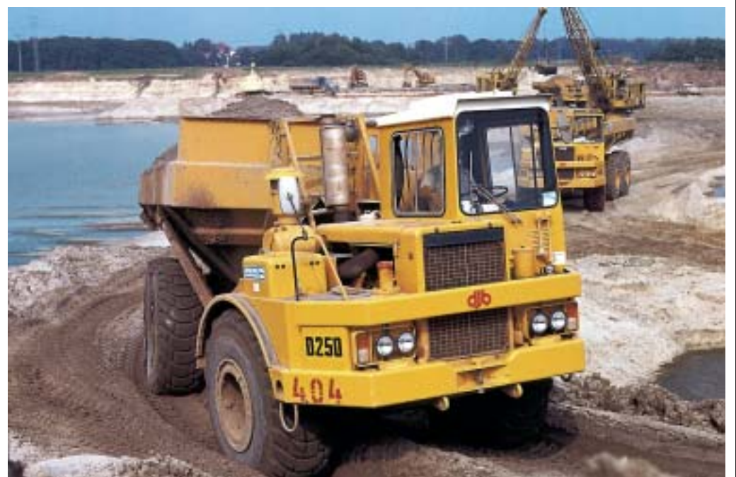
Die von Zeppelin ins Vertriebsprogramm aufgenommenen Knicklenker waren ohne aufwändigen Fahrbahnbau einzusetzen, was bei Erdbaustellen mit häufig wechselndem Verlauf der Fahrtrassen, auf Spülfeldern und beim Deichbau große Vorteile bot. Die DJB-Knicklenker von Zeppelin waren die Urformen der heutigen Cat-Maschinen.
