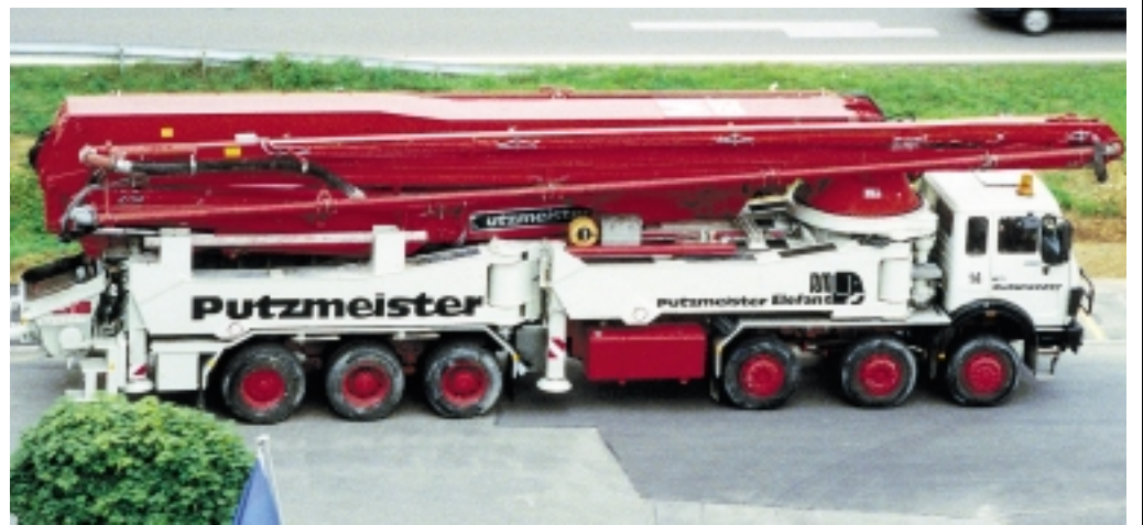
Zeichnete sich bereits 1986 durch einen großen Arbeitsbereich, baustellengerechten „Fünflings“-Mast, hohe Pumpleistung und kompakte Abmessungen aus: die Putzmeister-Großmast-Betonpumpe M 62-5.
