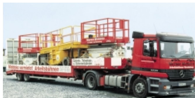
Ein schnelles und sicheres Verladen von Arbeitsbühnen bieten die neuen Satteltieflader von Blumenröhr, hier der Typ 1110-24000.
