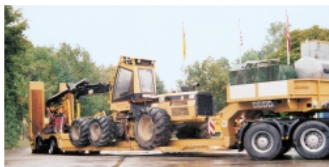
Speziell für Transporte durch Wälder konzipiert: Nootboom-Tiefladefahrer mit Stufenbett.
